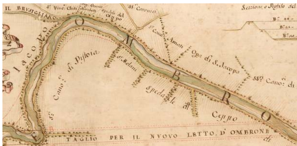
Fig. 6 – Viviani's raddrizzamento of the Ombrone (detail), 1700-1710, ink and watercolors on paper, Archivio di Stato di Pistoia, Deputazione sopra l'Imposizione del Fiume Ombrone, Cartoni e mappe.
